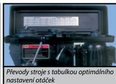
Převody stroje s tabulkou optimálního nastavení otáček
