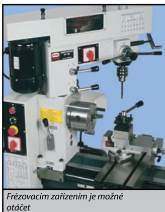
Frézovacím zařízením je možné otáčet
