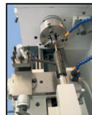
Slouží na zhotovení vnějších a vnitřních závitů pomocí závitovacích čelistí (oček) a závitníků. Použití především pro soustruhy PROMA, jednoúčelové stroje atd.
