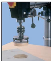
Truhláři jistě ocení vysoký výkon stroje při vykrúžování děr velkých průměrů pilovým děrovačem
