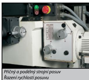
Příčný a podélný strojní posuv
