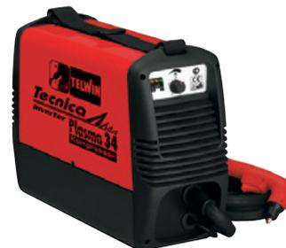
**TECHNOLOGY PLASMA** - Zařízení pro snadné dělení elektricky vodivých materiálů plazmovým obloukem, s kontaktním zapalováním pilotního oblouku. Zařízení vyniká svojí mobilitou. Má vlastní kompresor. Zabudovaná ochrana proti přepětí/podpětí, přetížení a tepelná ochrana. **Automatické chlazení hořáku.**
